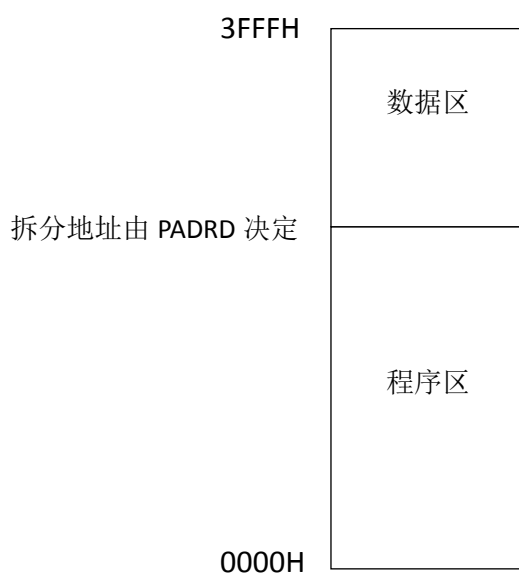
图 7-3-3 16K Flash 存储器结构
