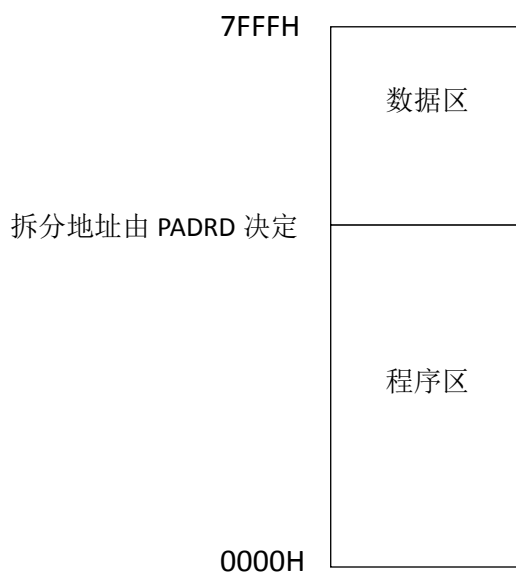
图 7-3-4 32K Flash 存储器结构
