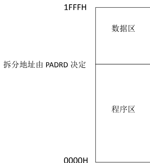
图 7-3-2 8K Flash 存储器结构
